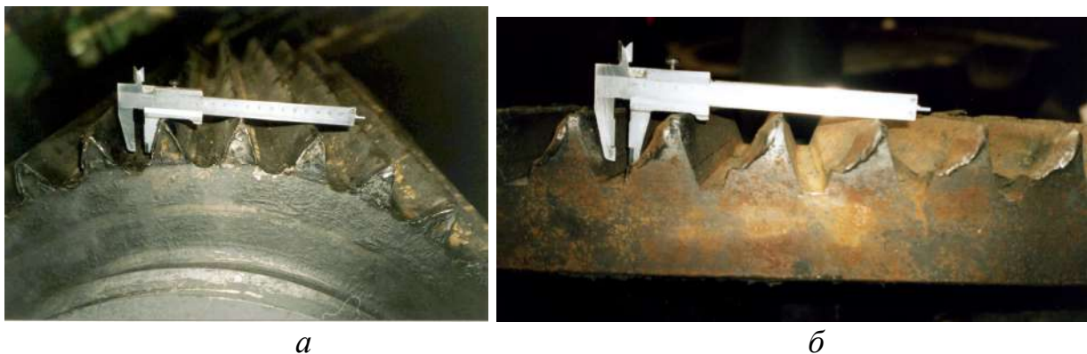
Рис. 1 – Характерне зношування евольвентних профілів зубів великомодульних вал-шестерень (а) і зубчастих вінців (б)
