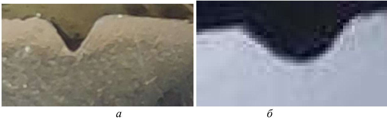
Рис. 5 – Поперечний переріз канавок, які отримано у зразках зі сталі 38ХН3МА (а) і бронзи ОЦС 5–5–5 (б) при заглибленні лінійного індентора
