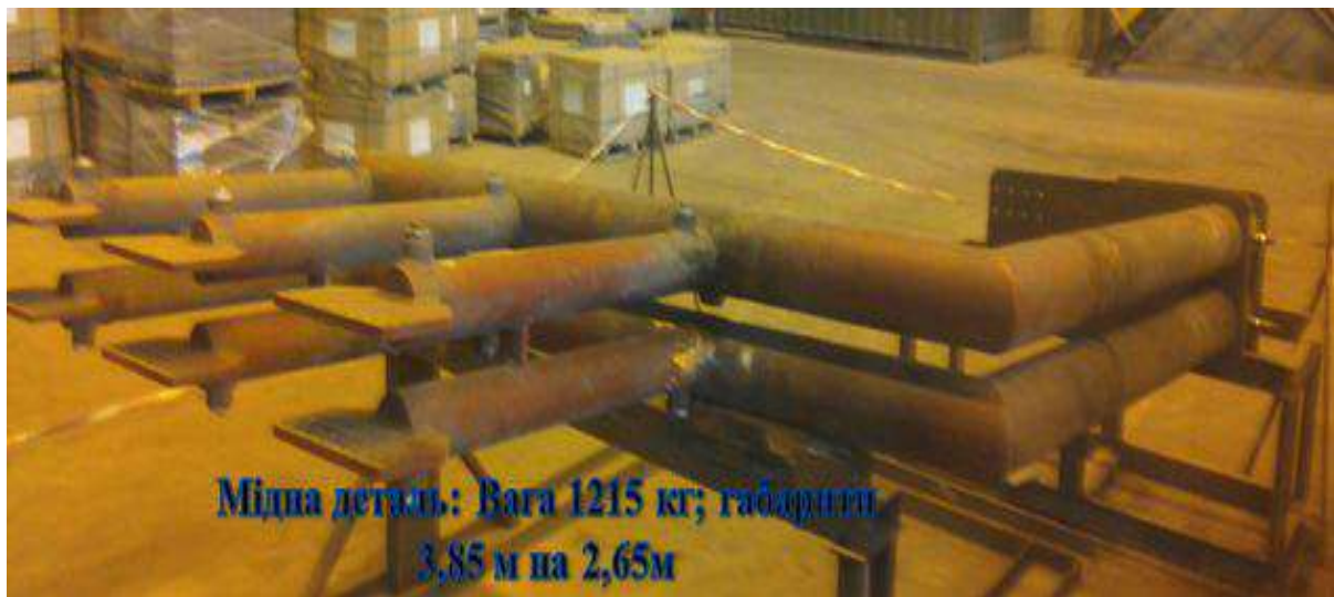
Рис. 1 – Зовнішній вигляд мідної водо охолоджуючої трубошини
